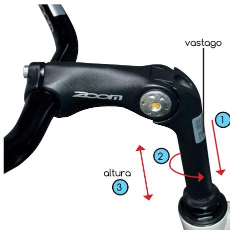
1. Insertar el vástago en el agujero delantero del tubo delantero del marco. Apretar ligeramente el perno en la parte superior. El vástago está marcado con una línea que marca el mínimo de seguridad que debe ser introducido en el tubo del marco. Dejar visible esta línea puede producir la rotura de manillar y un accidente.
