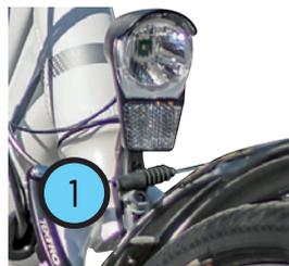
1. En los bicis con guardabarros colocar el soporte de la luz y la pletina del guardabarros alineando ambos al agujero de la horquilla y atornillar.
