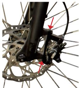
1. Normalmente el adaptador para las pastillas viene instalado al final del brazo de la horquilla delantera. Si no es así asegúrelo mediante el perno (M6 x 18) superior e inferior a los pitones con agujero de la horquilla izquierda. Entre las dos pastillas del freno debe haber una distancia de entre 3 y 4 mm.
