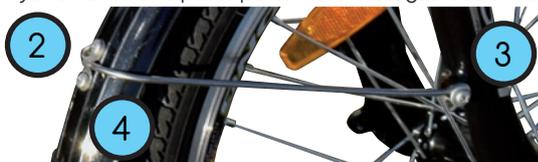
3. Atornillar con el tornillo (M5 x 14) y la arandela los puntas de la varilla al agujero de los brazos de la horquilla delantera.
